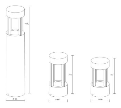
Ресурс работы светильника – не менее 50 000 ч; Сечение подводящих проводов (24V)- 5x0.75мм2, (220V)- 3x1,5 мм2
