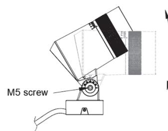
6. Отрегулируйте угол наклона светильника
