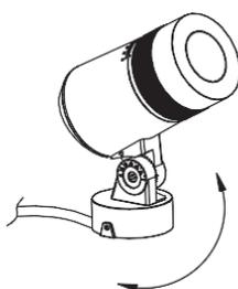
5. Зафиксируйте светильник при помощи винтов M5
