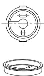
2. Просверлите два отверстия, согласно чертежам на закладную
