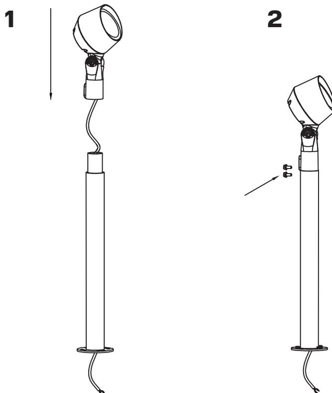
Шаг 3: Установите опору со светильником на монтажную поверхность.
