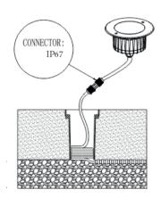
Подсоедините кабель питания к прибору. Сохраняйте достаточную длину кабеля для обслуживания прибора.
