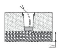
Установите монтажный стакан в землю, верхняя сторона должна быть на одном уровне с поверхностью земли, кабель питания должен проходить через монтажный стакан. Примечание: высота гравийной подушки должна составлять не менее 25 см.
