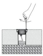
Закрепите прибор в монтажном стакане при помощи отвертки.
