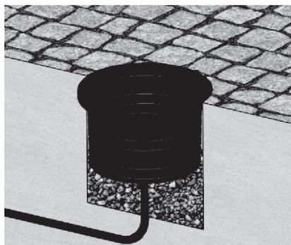
В соответствии с шагом 3, установите светильник в монтажный стакан.
