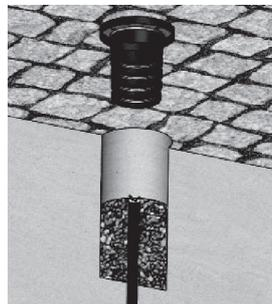
В соответствии с шагом 3, установите светильник в монтажный стакан.
