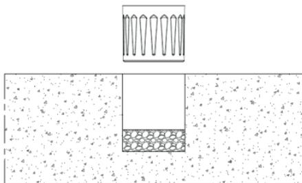
Шаг 1. Перед установкой монтажного стакана в грунт уложите в монтажном отверстии песчаную подушку глубиной не менее 20 см.
