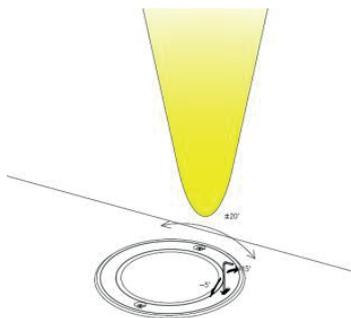
Шаг 4. Произведите настройку прибора. Направление светового потока можно регулировать в пределах от  $-5^{\circ}$  до  $+15^{\circ}$  в вертикальном направлении и от  $-20^{\circ}$  до  $+20^{\circ}$  в горизонтальном направлении.
