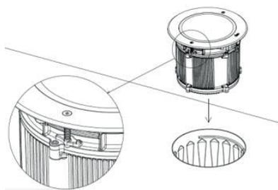
Шаг 3. Установите световой прибор в монтажный стакан.
