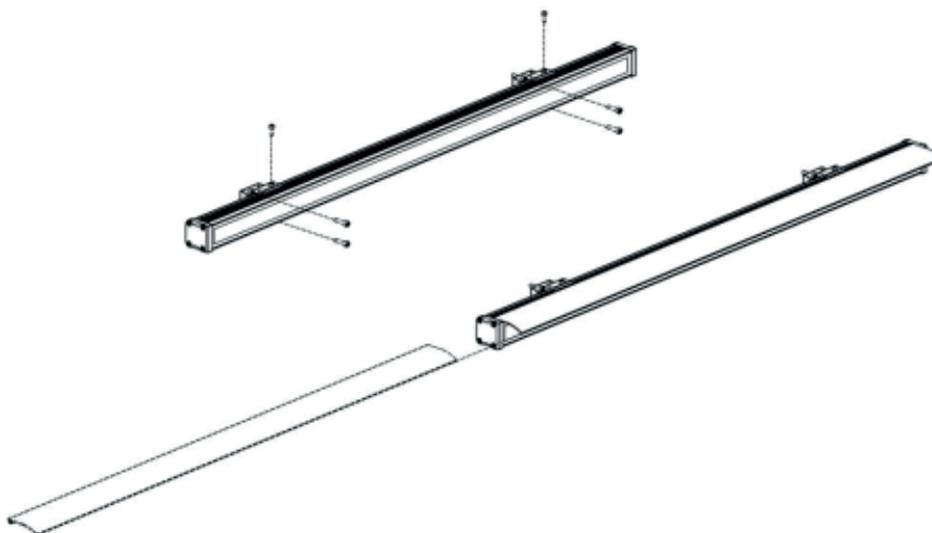
3. Отрегулируйте угол поворота светильника и зафиксируйте его
