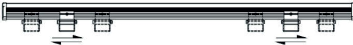
2. Закрепите кронштейн к монтажной поверхности и зафиксируйте его к светильнику, затем установите шторку, если потребуется
