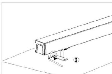
Шаг 2. Отрегулируйте угол наклона. Затяните винты, чтобы зафиксировать положение светильника.
