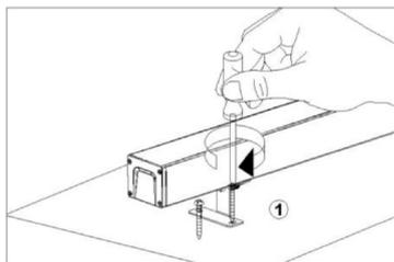
Шаг 1. Закрепите прибор на монтажной поверхности при помощи винтов и отвертки. Проверьте точку крепления.
